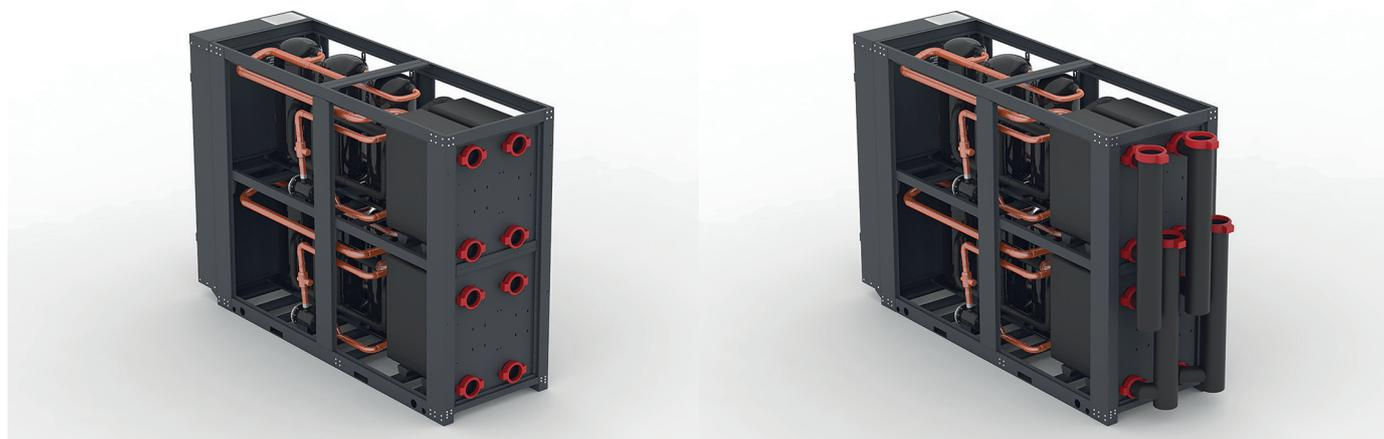
2х контурные чиллеры имеют два полностью независимых контура, для обеспечения повышенной надёжности. На объекте при монтаже вода от каждого из двух испарителей/конденсаторов может быть объединена в один трубопровод. Кроме этого, Вы можете заказать коллекторы заводского исполнения. Коллекторы будут включены в состав станций охлаждения воды.
