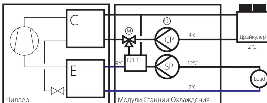
Когда температура воздуха ниже, чем температура воды, возвращающейся из системы, установка начнет охлаждение рассола в драйкулере. После этого вода системы будет охлаждаться рассолом бесплатно. Компрессоры будут работать меньшее время, снижая энергопотребление. Установка будет работать круглогодично.
