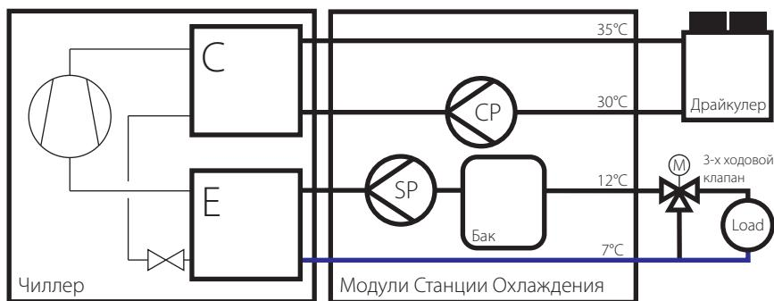
Вы можете добавить проточный бак в станции охлаждения воды Felzer.
