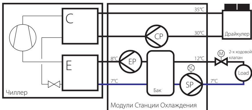
Система VWF включает бак гидро-разделитель с 4мя подключениями и насос испарителя сверхнизкого давления и энергопотребления, который постоянно обеспечивает требуемый расход на испарителе.
